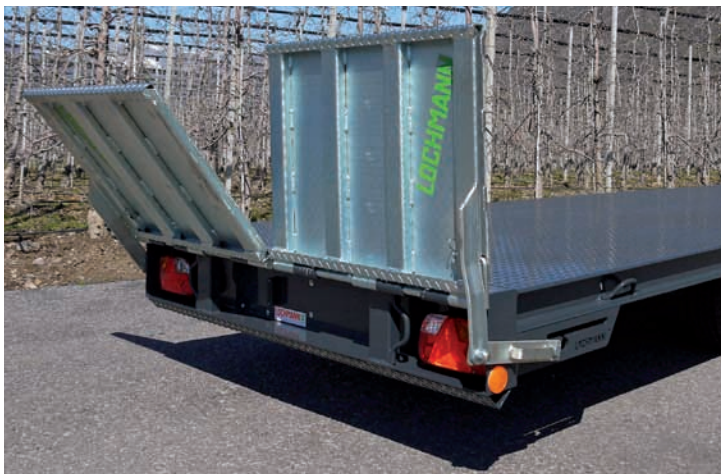
Rampen mit serienmäßigem Schnellverriegelungssystem
