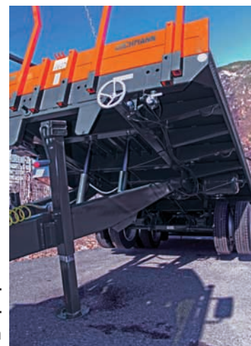
Stahlrohr- Rahmen- konstruktion
