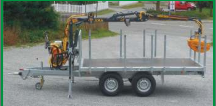
F3-H mit Farma C3,8, LKW-Zugöse [5] und Funkseilwinde [6]
