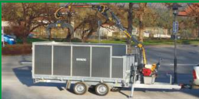
F3-H mit Farma C3,8 und Alu-Blechwand mit Rahmeneinfassung und Heckpendeltüre [4]
