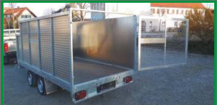
F3-H mit Farma C3,8 und Alu-Blechwand mit Rahmeneinfassung und Heckpendeltüre [4]
