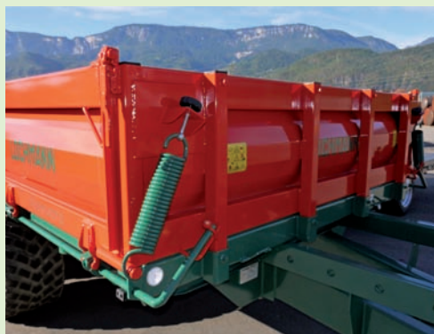
Die Modellreihen ab RM 140 T: Stärker als je zuvor mit 60 mm starken Spezialbordwänden und versenkten Verschlüssen
