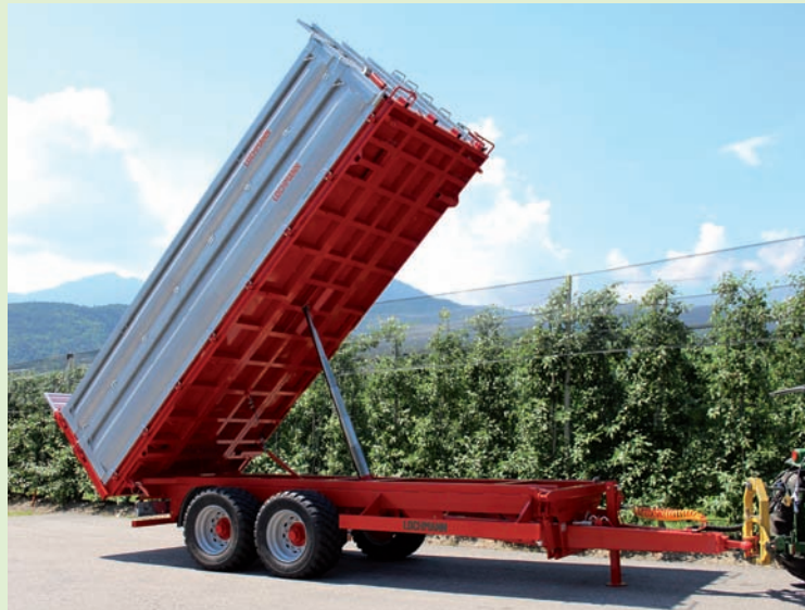
RM 180 T mit hydraulischer Deichselfederung
