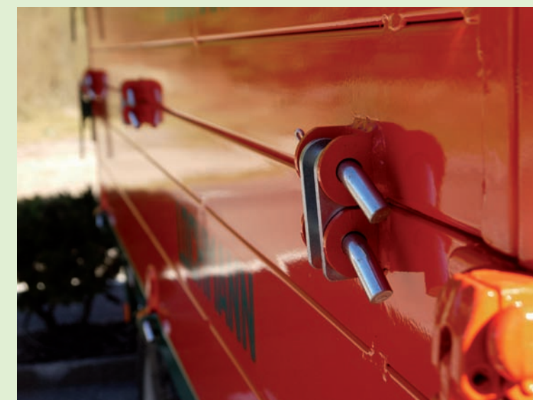
„Lochmann Duo-Lock“ Scharniere für Aufsatzwände mit 3 Funktionen
