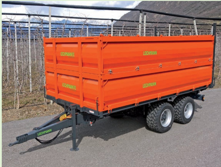
RM 140 T mit polygonalen Stahlbordwänden und Aufsatzwänden
