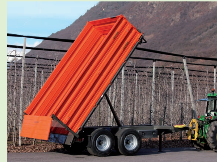
Heckklappe hydraulisch (nur ohne Kippmatik möglich)
