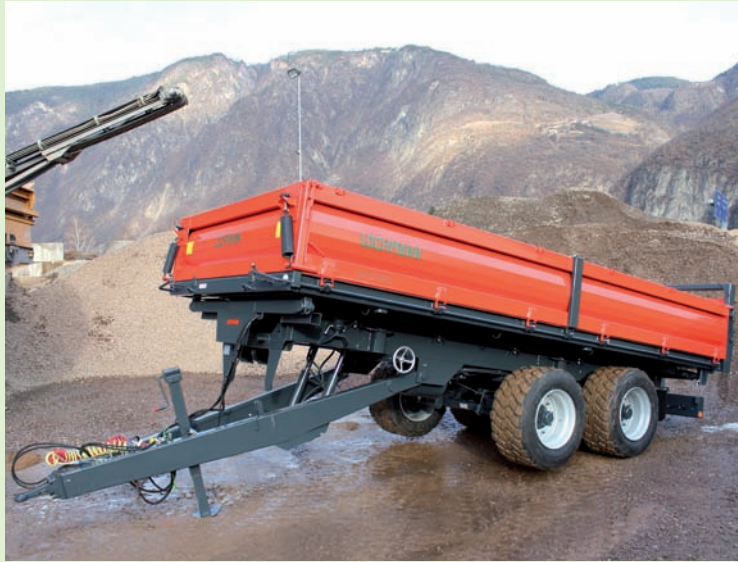
Deichselfederung / Brücke hydraulisch schwenkbar
