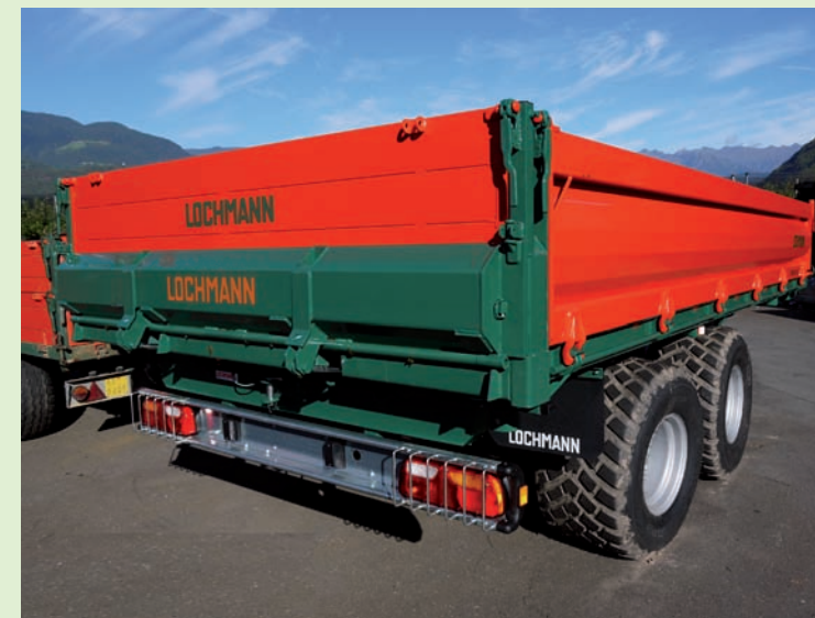
Heckklappe hydraulisch (nur ohne Kippmatik möglich)
