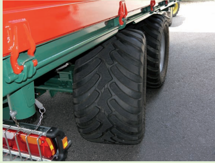
Lenkachse als Nachlaufachse oder mit Zwangslenkung
