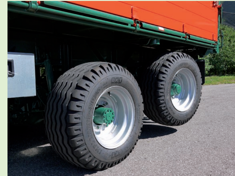
Liftachse (Achse hydraulisch heben)
