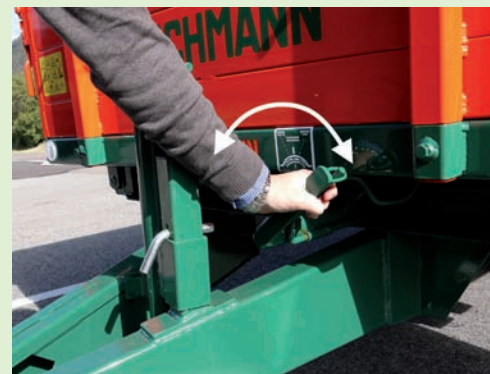
„LOCHMANN-KIPPMATIK“, zentralisierte Kipplagersteuerung
