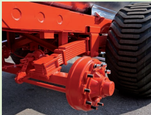
Tandem Modelle: mit Bogie-Aufhängung pendelnd und gefedert
